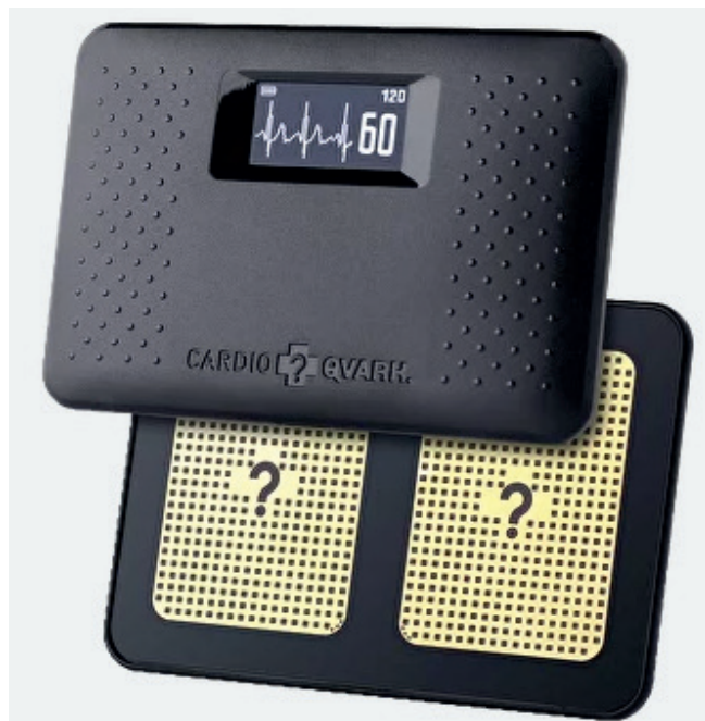
Рис. 6. Цифровой беспроводной регистратор ЭКГ КардиоКарта (из открытых источников) 1 .
