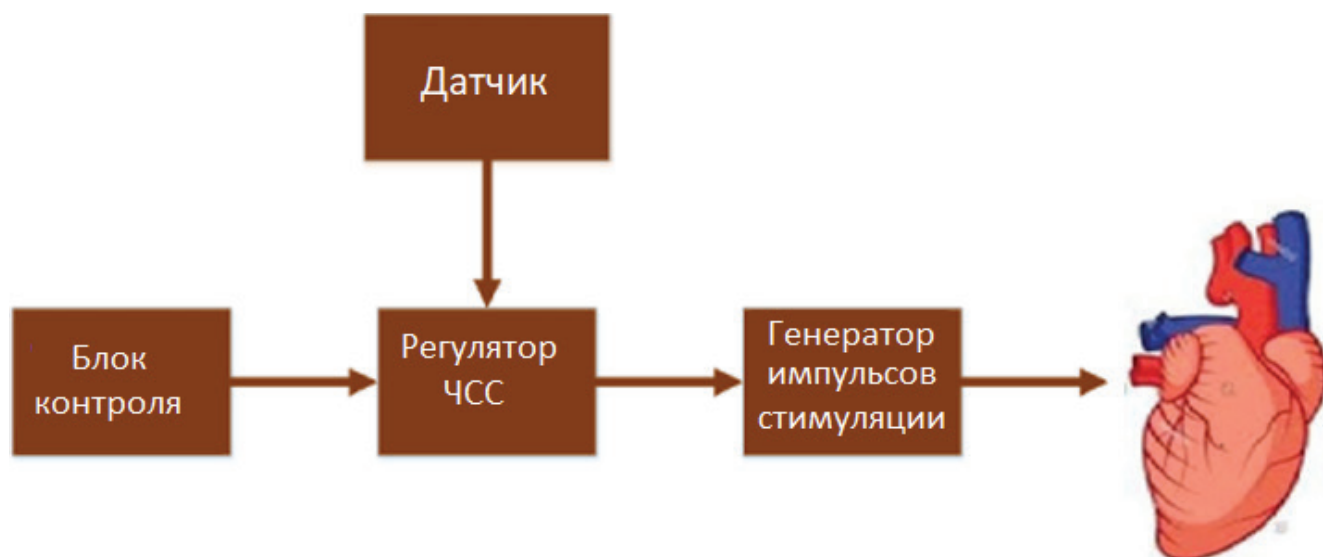
Рис. 1. Схема кардиостимулятора с частотной адаптацией сердечных сокращений.
