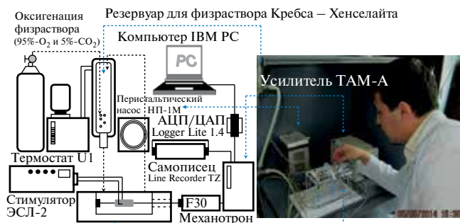
Рис. 2. Блок-схема установки для регистрации сократительной активности препарата папиллярной мышцы сердца крысы.
